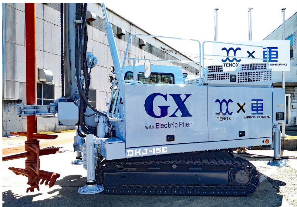
電動小型杭打機「DHJ-15E」試作機
