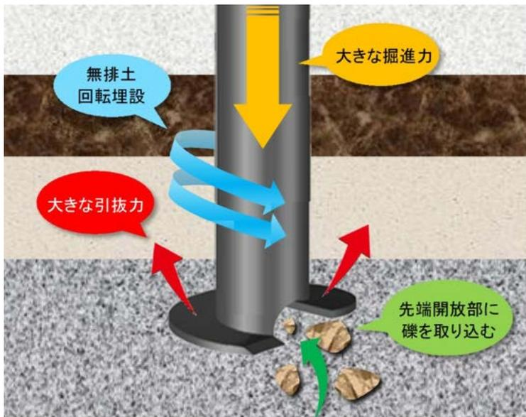
木ねじ原理の大きな掘進力、砂礫・玉石層においては杭先端の開放部に掘削障害を取り込みながら貫入します。原位置土を乱さないため、被圧水などの自噴への抑え込み効果が発揮できます。
