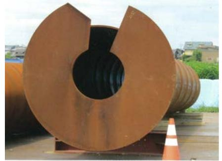
NSエコパイル鋼管杭先端部
